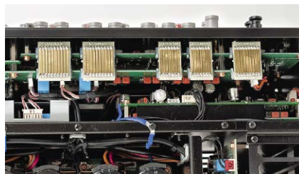
W komorze przy tylnej ścianie umieszczono przedwzmacniacz z selektorem wejść i regulacją głośności oraz zabezpieczenia wyjściowe.
